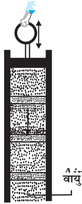
चित्र 14.4 पिस्टन को आगे-पीछे गति कराकर वायु से भरी नली में ध्वनि तरंग उत्पन्न की जाती है। चूँकि वायु-अवयव के दोलन तरंग गति की दिशा के समांतर हैं, अतः यह अनुदैर्घ्य तरंग है।
